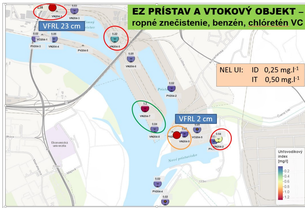
Obr. 10 Oblasť výskytu voľnej fázy ropných látok a zvýšených hodnôt NEL UI v Prístave a pri Vtokovom objekte Malého Dunaja
