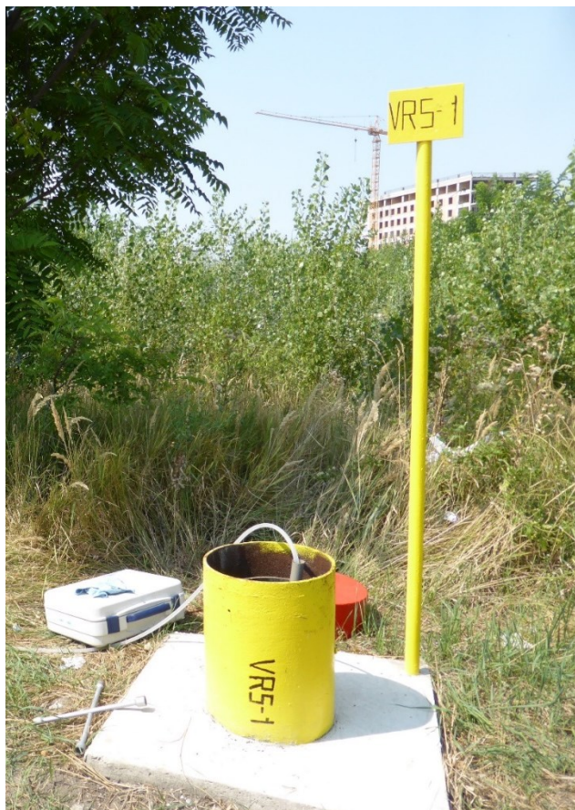
Rekonštruovaný vrt VR5-1 (Gumon)
