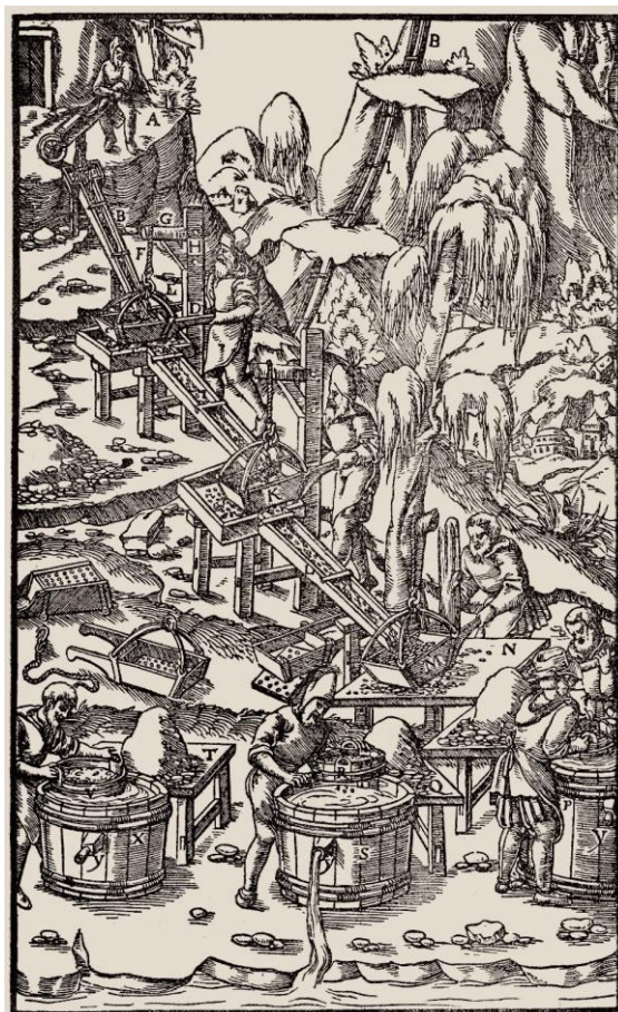
Obrázok 4 – Úprava medených rúd v diele J. Agricola: „Dvanásť kníh o baníctve a hutníctve“, Bazilej, r. 1556
