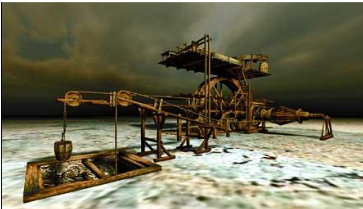
Obrázok 7 – Drevený ťažný stroj poháňaný vodou, Ludovika šachta. Vizualizácia drevených častí objektu s ťažným strojom (autor J. Scholtz ml.).
