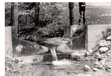
Meranie výdatnosti prameňa Bielej vody pri obci Muráň kombinovaným priepadom
