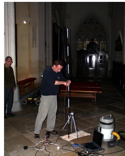
3. vsunutie kamery do otvoru
