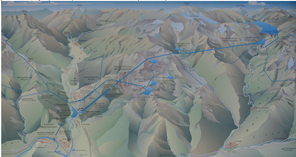
Schéma sústavy vodných diel Malta - Reisseck
