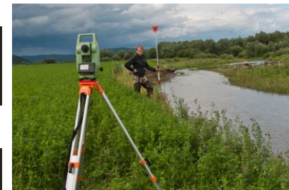
Zameranie vlčovacích bodov totálnou stanicou Leica TCR 307.
