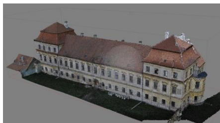
3D model objektu vyskladaný z nalietavých snímok.
