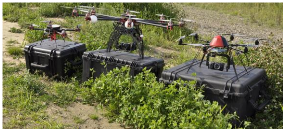
Malé bezpilotné zariadenia – mikro UAV. quadro-, okto-, hexa-.
