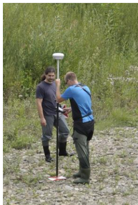
Zameranie vlčovacích bodov pomocou RTK
