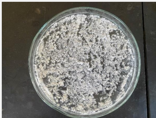
Obrázok 1: Biele kryštáliky vodného výluhu (s aktívnym uhlím) guadrónu PO II. - 20/2.
