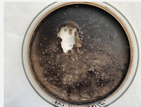
Obrázok 2: Zvyšok vodného výluhu guadrónu PO II. - 20/2 po odparení (bez aktívneho uhlia).
